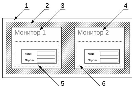
Рис. 1: Архитектура MST: сначала запускается основной X-сервер (1); затем поверх него запускается тайловый оконный менеджер Awesome (2); в Awesome на каждом мониторе разворачивается окно процесса Xephyr, которое порождает вложенный X-сервер (3,4); внутри каждой Xephyr-сессии запускается менеджер входа в систему LightDM (5,6).
